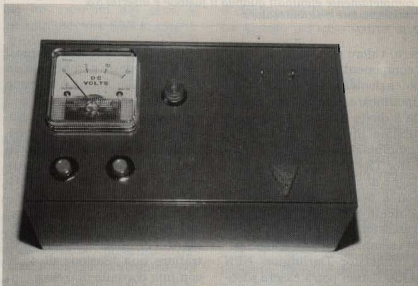
Il battery test a realizzazione ultimata.
