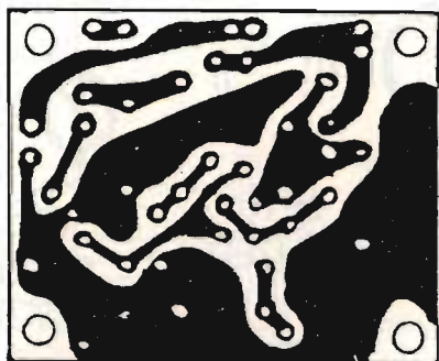
Figura 2. Circuito stampato, in scala 1:1.
